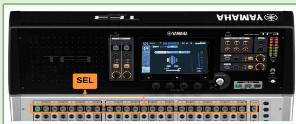
Imagen 20. Previsualizar la función del canal.
