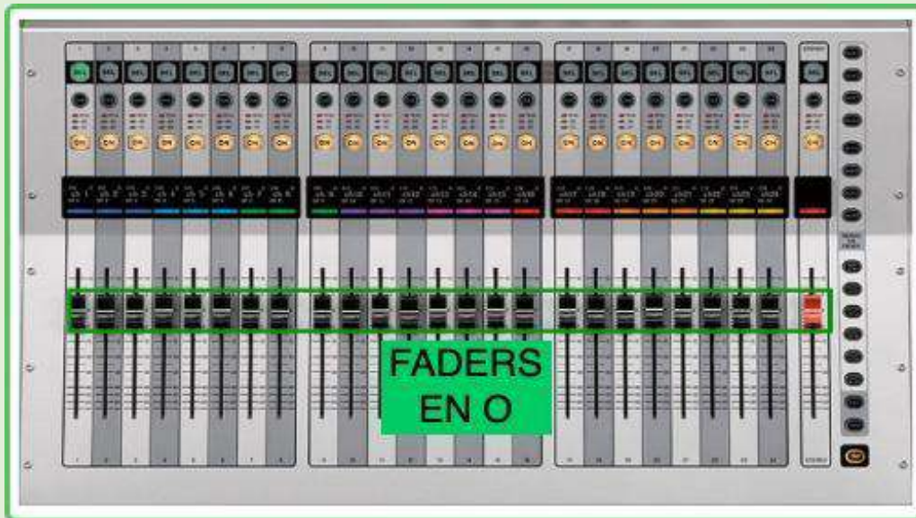
Imagen 21. Faders de la consola de audio en 0.
