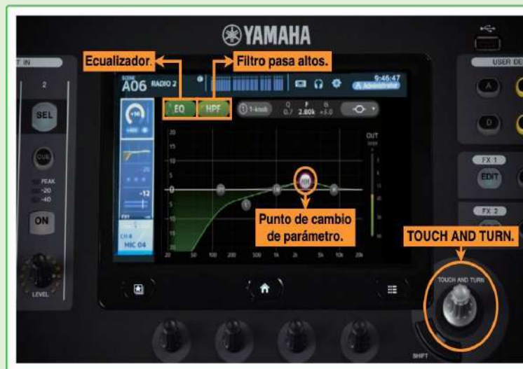
Imagen 19. Ajustes del ecualizador y filtro pasa altos.
