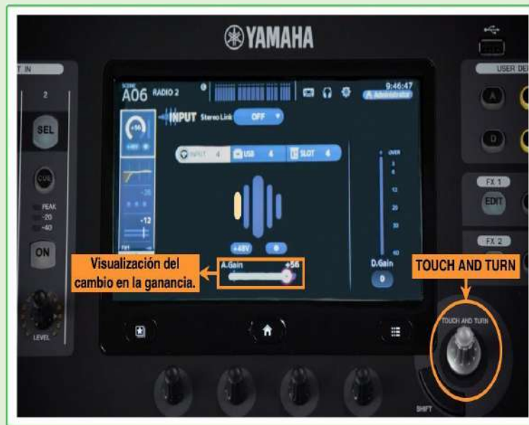
Imagen 18. Ajustes de ganancia en la consola de audio TF3.
