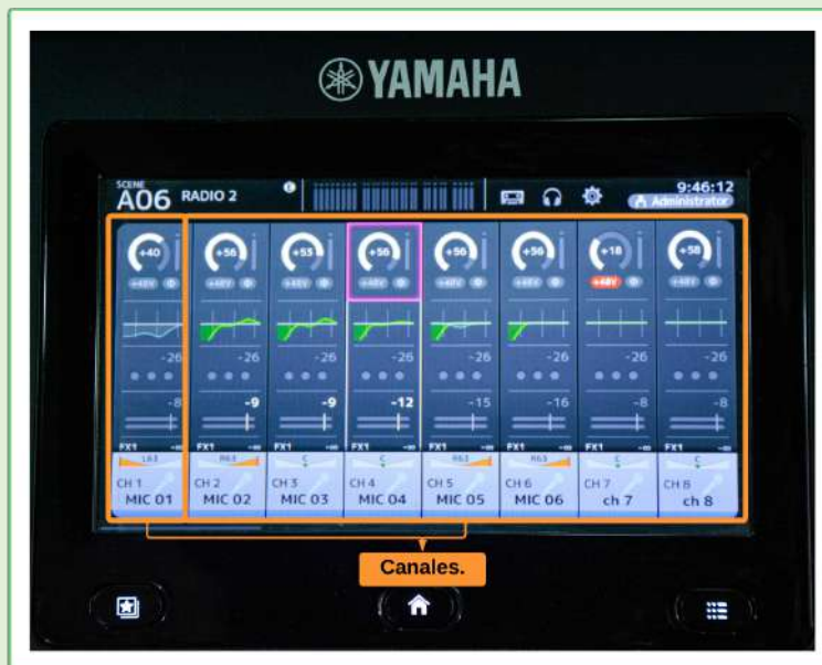
Imagen 15. Canales de la consola de audio TF3.
