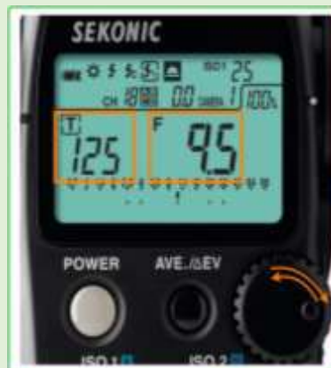
Imagen 19. Configuración de la velocidad de obturación [T] y el valor de apertura [F].
