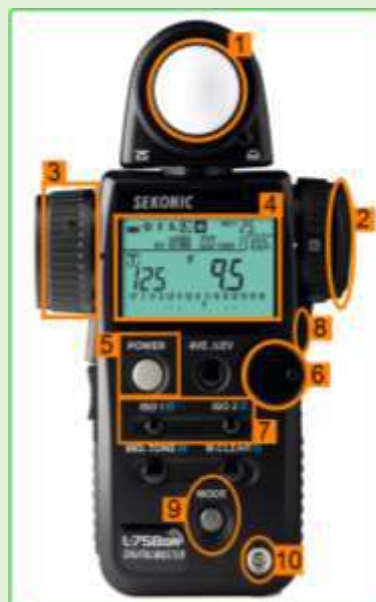
Imagen 15. Partes del exposímetro Sekonic L-758.
