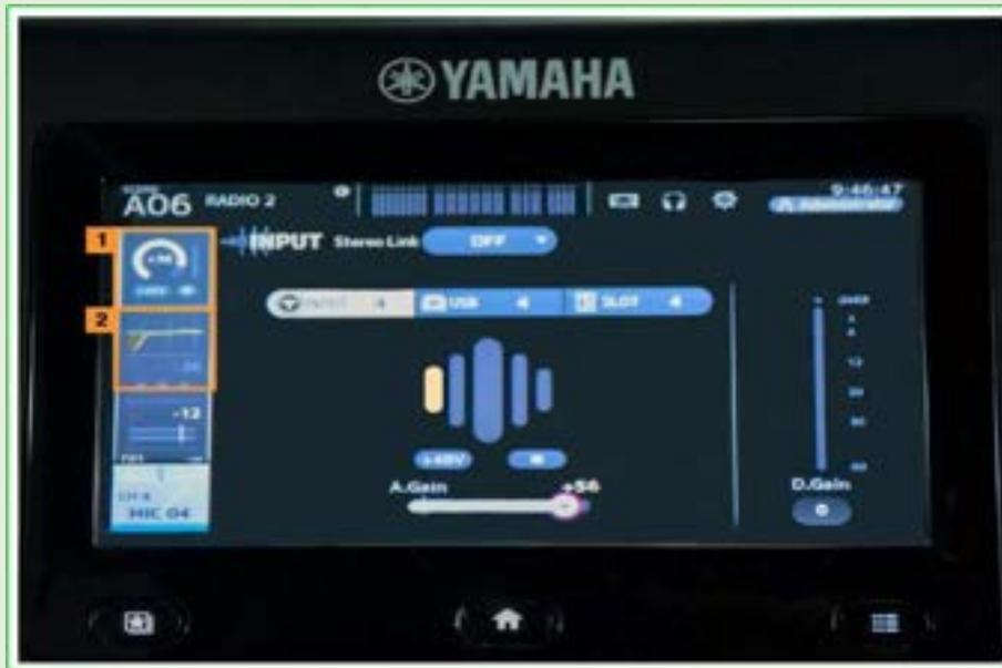
Imagen 17. Ajustes del canal seleccionado.
