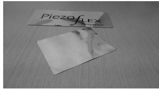
Figura 1. Material activo PVDF-TrFE con metalización en aluminio.
