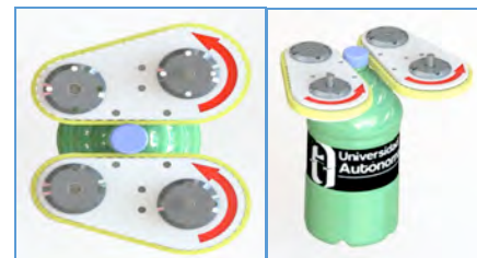
Figura 4. Mecanismo de tapado con bandas laterales.
