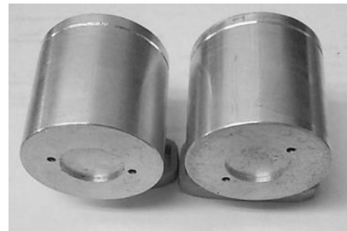
Figura 6. Transductores construidos a partir de PVDF-TrFE.
