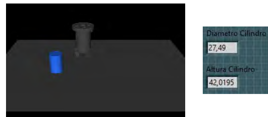
Figura 10. Entorno 3D reconstruido. Características del cilindro.
