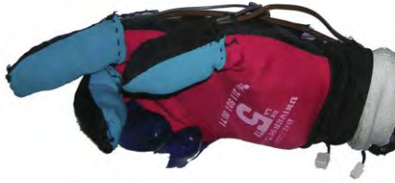
Figura 3. Guante de datos de 5 dedos con acelerómetros.
