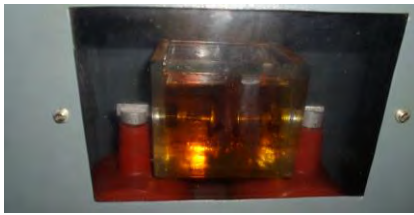
Figura 6 Prueba de rigidez dielectrica realizada a los materiales aislantes a usar.
