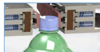
Figura 5. Sistema con resortes de las bandas de roscado.
