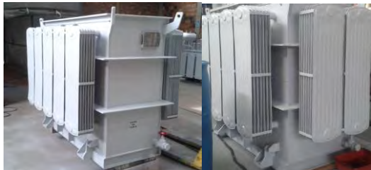
Figura 9 cuba de radiadores
