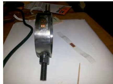
Figura 3. Instalación de las galgas extensiométricas
