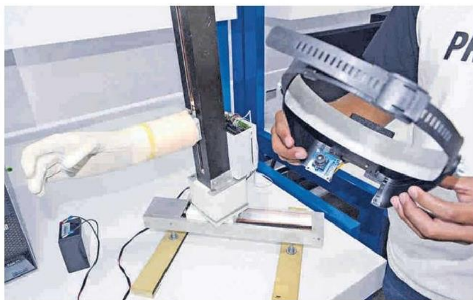
Brazo mecatrónico con movimientos articulares y una visera ajustable a la cabeza del paciente. FOTO: TECNÓSFERA
